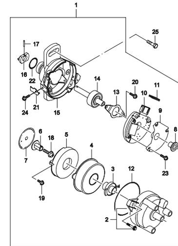
**1710 СИСТЕМА ЗАЖИГАНИЯ (0.8MPI)**
