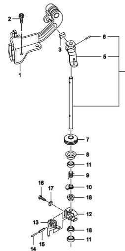
**3250 МЕХАНИЗМ ПРИВОДА УПРАВЛЕНИЯ КПП (1.0МРІ)**
