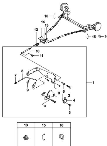
**4610 ГИДРАВЛИЧЕСКИЙ ПРИВОД ТОРМОЗА**
