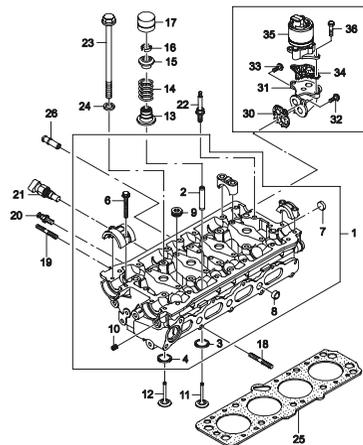
**1320 КОРПУС РАСПРЕДЕЛИТЕЛЬНОГО ВАЛА (СОНС)**
