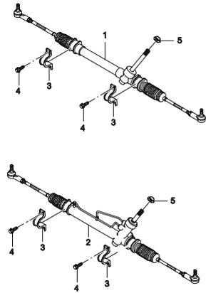
**4930 РУЛЕВОЙ МЕХАНИЗМ С ГИДРОУСИЛИТЕЛЕМ**
