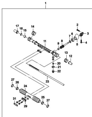
4930 РУЛЕВОЙ МЕХАНИЗМ С ГИДРОУСИЛИТЕЛЕМ
