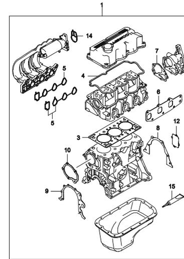
1110 ДВИГАТЕЛЬ В СБОРЕ (0.8MPi)
