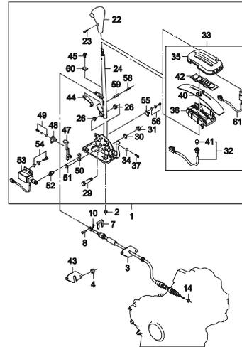
3910 РЫЧАГ ПЕРЕКЛЮЧЕНИЯ ПЕРЕДАЧ (М/Т)
