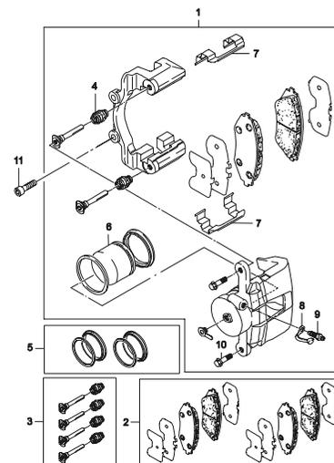
**4520 ТОРМОЗНОЙ МЕХАНИЗМ ЗАДНЕГО КОЛЕСА**
