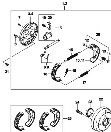
**4610 ГИДРАВЛИЧЕСКИЙ ПРИВОД ТОРМОЗА**
