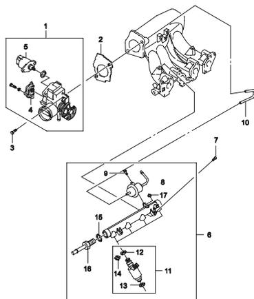
**1411 СИСТЕМА ВПРЫСКА ТОПЛИВА (1.5 ДОНС)**
